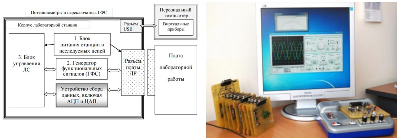
Рис. 1. Функциональная схема комплекса (а) и общий вид (б)
